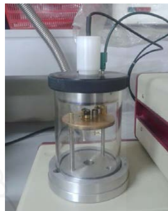
ภาพที่ 7 การฉาบผิวชิ้นงานตัวอย่าง
