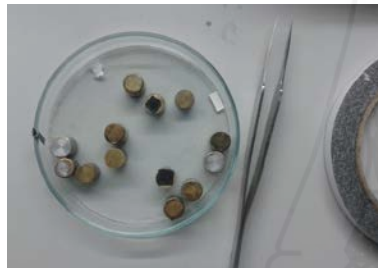
ภาพที่ 6 แท่นสตั๊ปและเทปกาวยสองหน้า
